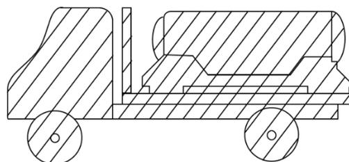
エ 被けん引車形式の移動タンク貯蔵所の例
