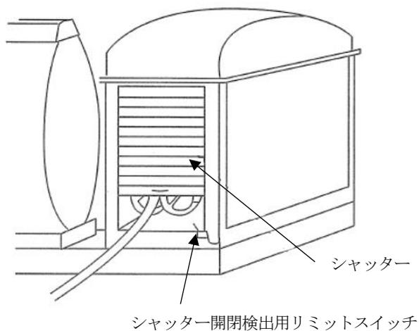
第9-71 図 給油設備の扉による方法の例
