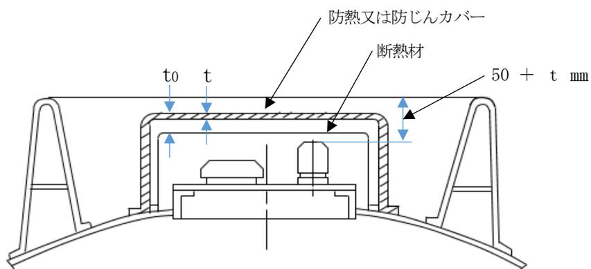
例3 防熱又は防じんカバーの間に断熱材が張り付けられているもの
