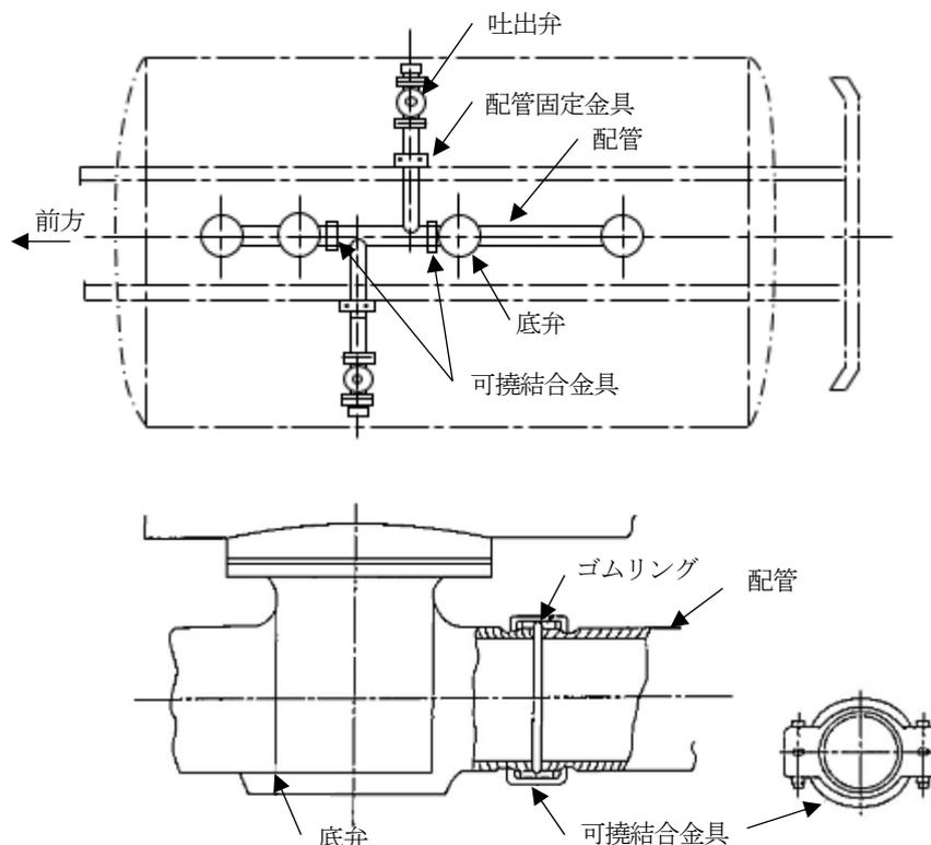
第9-44 図 緩衝用継手による方法
