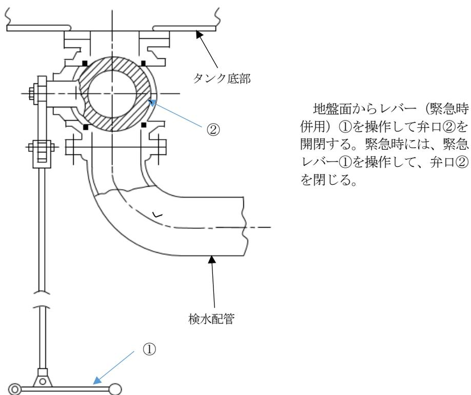
第9-35 図 底弁の構造例
