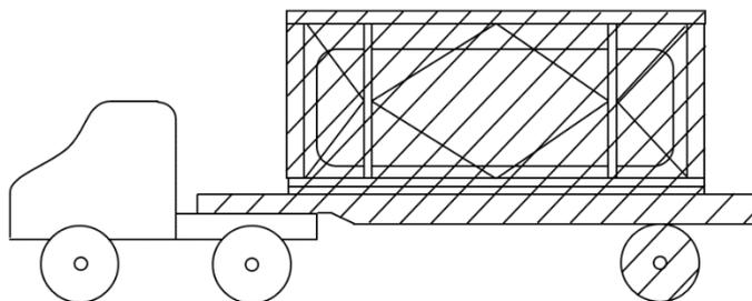
第9-1図 移動タンク貯蔵所の車両の種類
