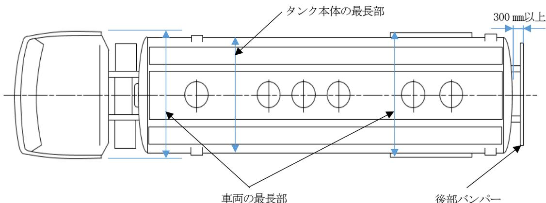
第9-57 図 最大容量が20KLを超える移動タンク貯蔵所のタンク本体の位置の例
