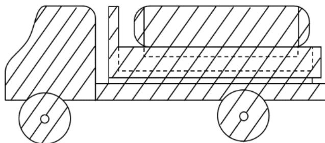
(7) 貯蔵タンクの固定方法で、板厚が3.2mm以上6mm未満、容量4,000Lのタンクに、受台、脚、ステージ等を溶接し、又はボルト締めによって強固に取り付け、これらの受台、脚、ステージ等をUボルト等でシャーシフレームに強固に取り付けた場合には、積載式以外の移動タンク貯蔵所と認められる。【昭37.4.6 自消丙予発第44号】
