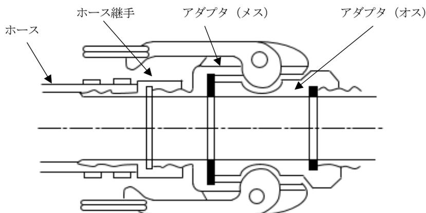
第9-46 図 突合せ固定式結合金具の構造例
