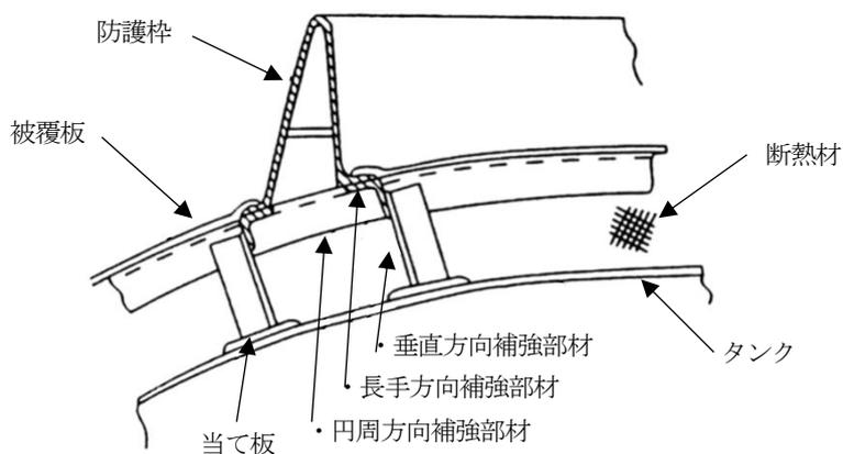
第9-30 図 被覆板の下部に補強部材を設ける防護枠（溶接接合する場合）
