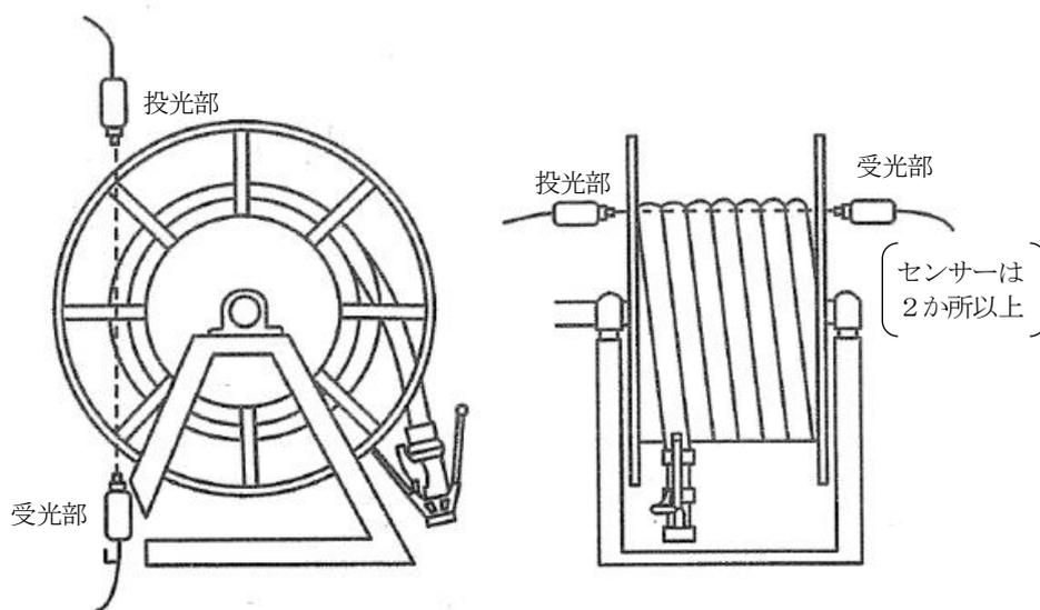
第9-69 図 ホース巻取装置により検出する方法
