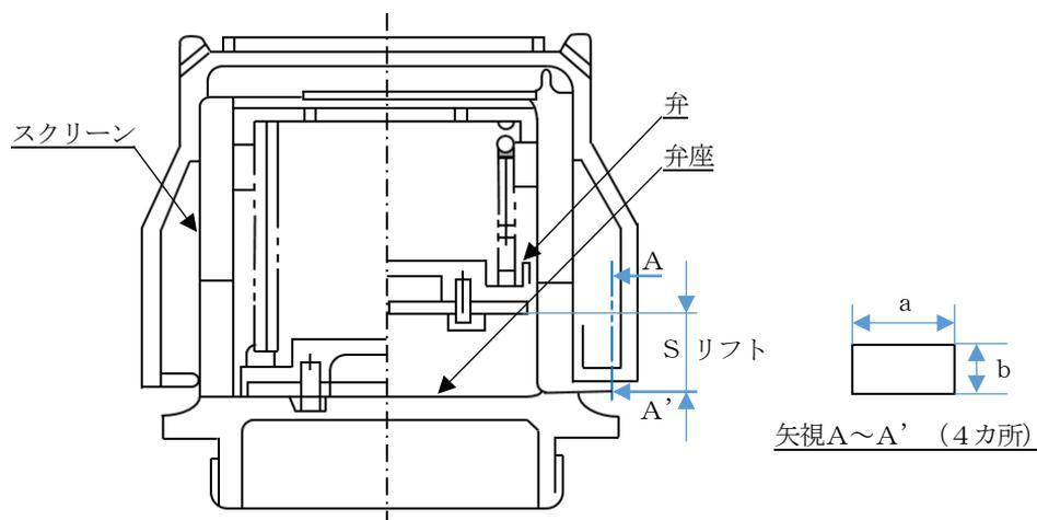
e 有効吹出し面積は、2個以上の安全装置によって確保することができる。この場合は、それぞれの安全装置の有効吹出し面積の合計が所定の有効吹出し面積以上となれば足りること。
