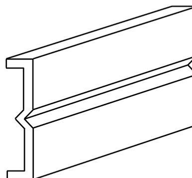
第9-8図 防波板の構造
