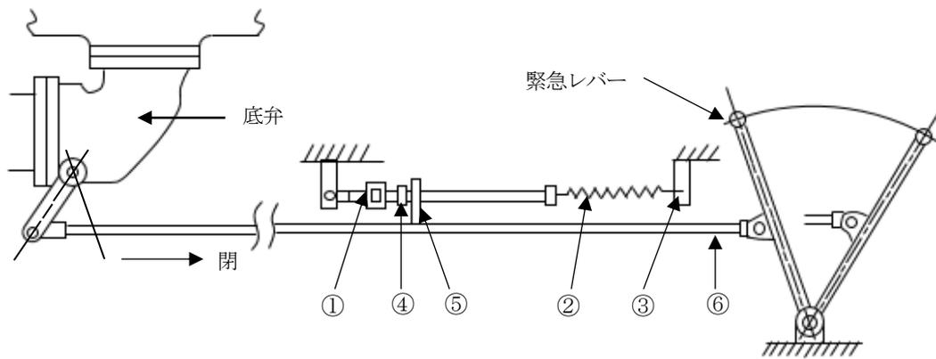
易溶性金属①が火炎によって加熱され溶断すると、易溶性金属と接続されているばね②がばね固定ピン③の方向に縮むので、ストップ④が受金⑤、ロッド⑥を押し動かすこととなり、底弁が自動的に閉鎖される。
