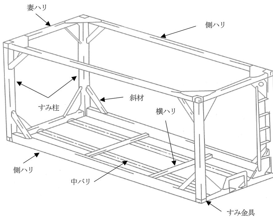
第9-62 図 箱枠の部材名称及び構造
