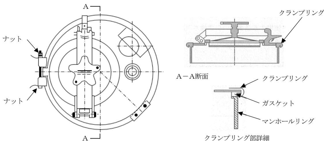
第9-10 図 クランプリング方式のマンホールカバーの例
