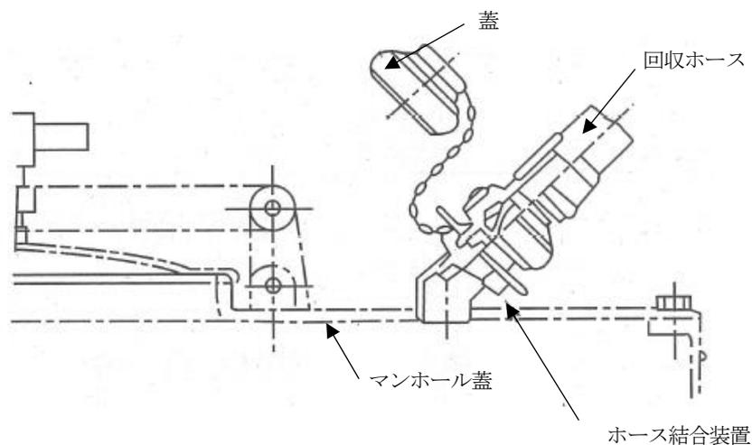
第9-12 図 ホース結合装置の構造の例
