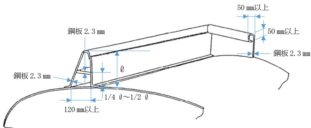
(注) 前部は、直径50mm以上の上部折り曲げ形構造又はパイプ溶接構造とすること。
