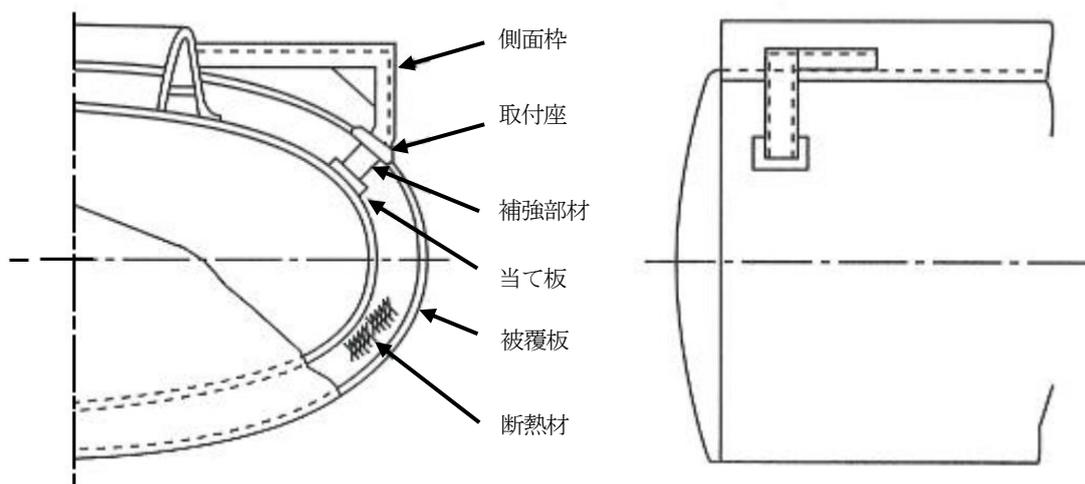
第9-22 図 外板の下部に補強部材を設ける側面枠の例
