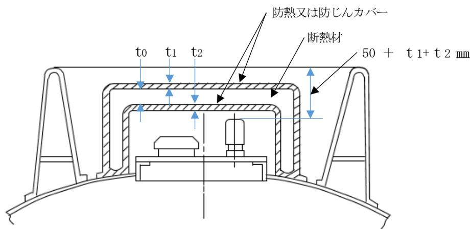
第9-28 図 防熱又は防じんカバーを設ける移動貯蔵タンクの防護枠
