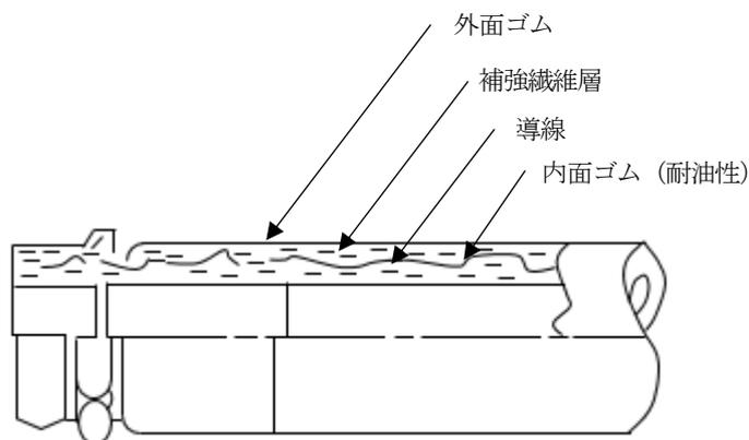
第9-75 図 静電気を導通させる給油ホースの例
