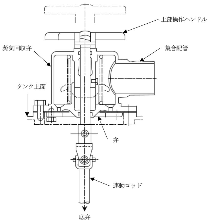
第9-14 図 蒸気回収弁の構造例
