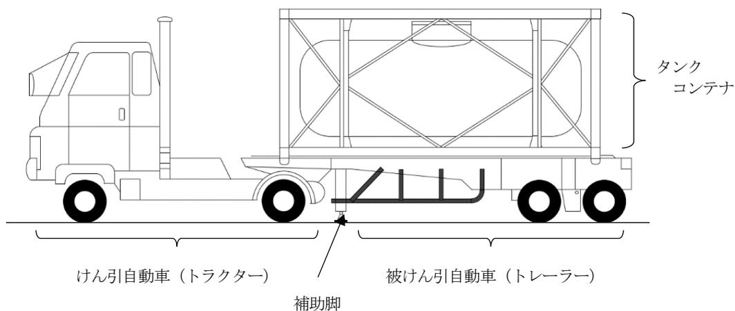
第9-65 図 タンクコンテナを積載した自動車
