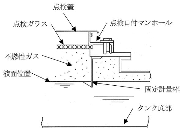
第9-50 図 計量時の静電気による災害を防止するための装置
