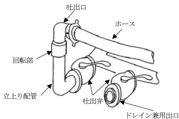
第9-49 図 配管先端部の構造例
