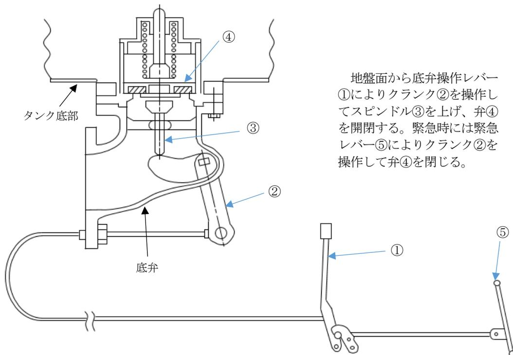
例2-2 地盤面上において底弁を開閉する構造のもの（検水配管底弁）
