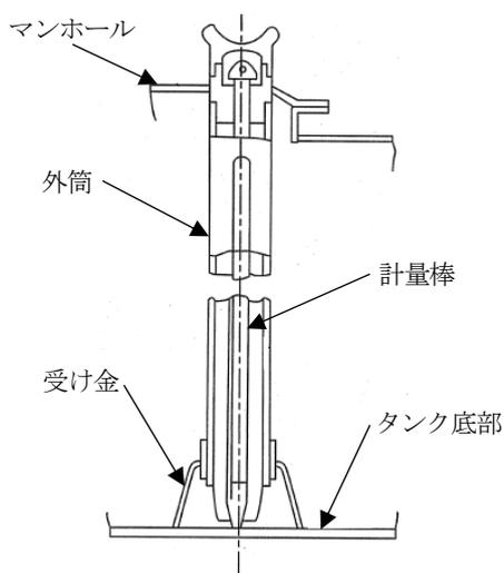
例2 外筒をボルトで取り付ける例
