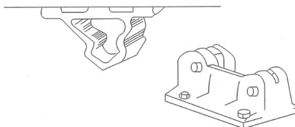
第9-60 図 計算による強度計算を行う必要のない緊締金具及びすみ金具の例
