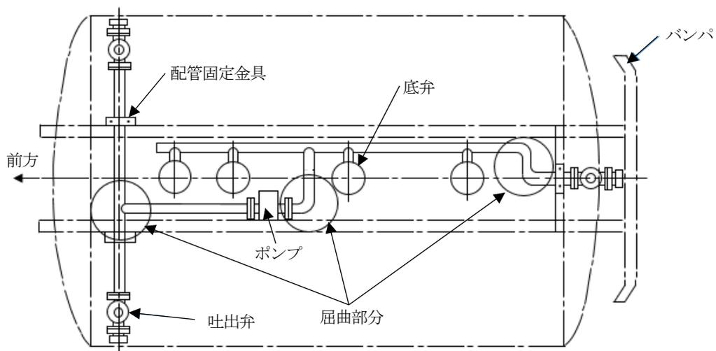
第9-42 図 配管による方法
