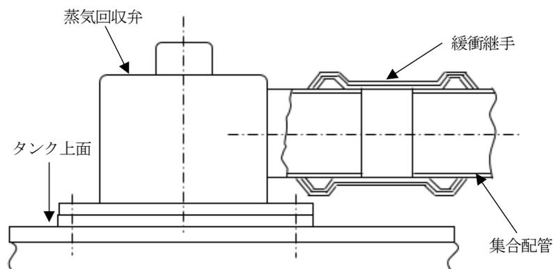
第9-15 図 蒸気回収弁と集合配管との接続例
