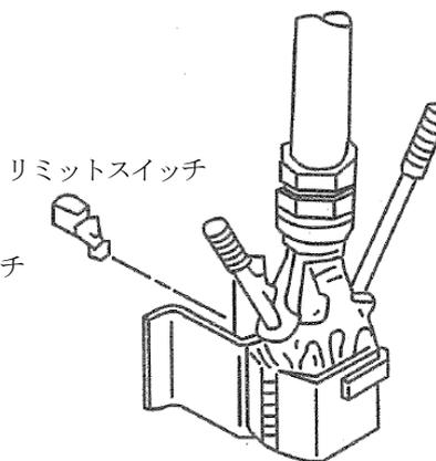
例3 結合金具式ノズル格納具の場合
