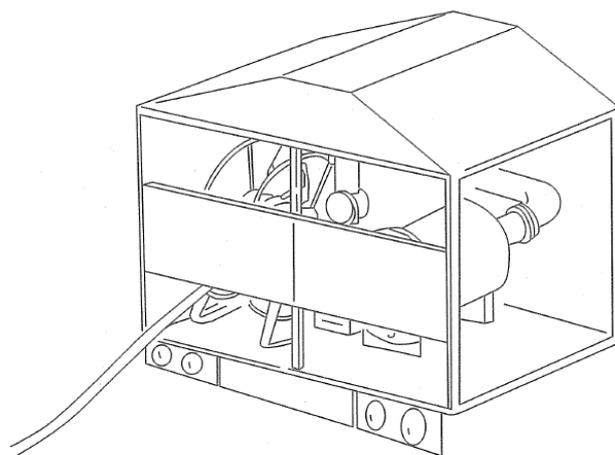
第9-72 図 給油設備の扉による方法として認められない例
