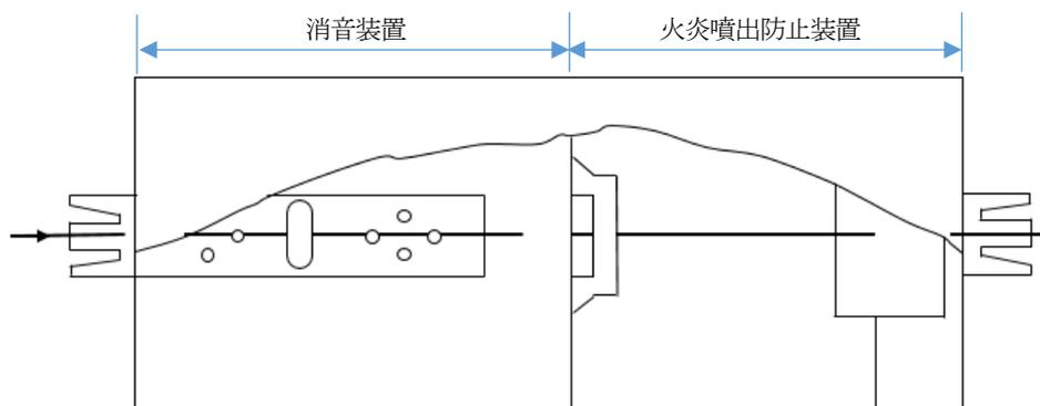
第9-68 図 消音装置と火炎噴出防止装置を一体として取付ける場合の例
