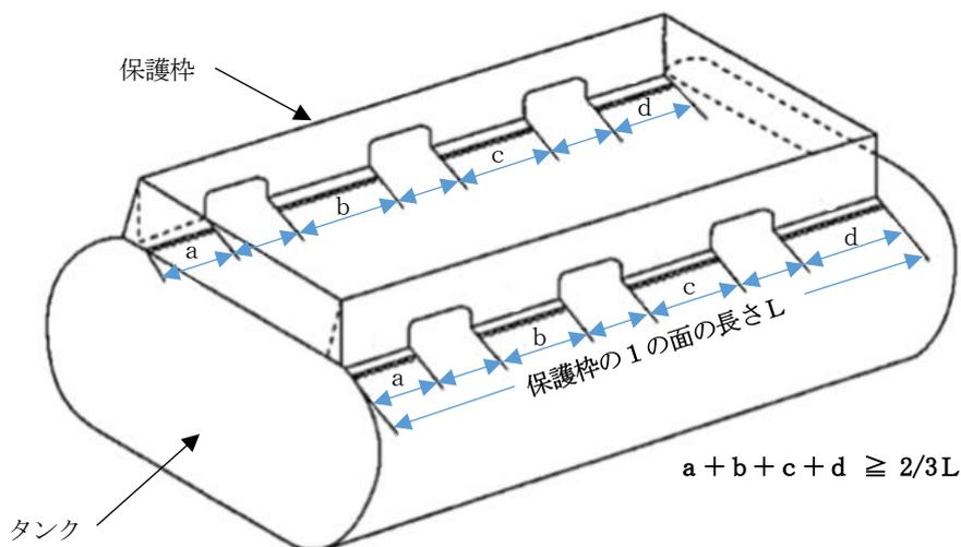
第9-33 図 防護枠とタンク胴板との間の溶接線の減少例
