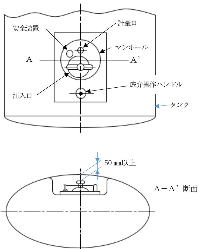
第9-27 図 附属装置が陥没しているタンクの例
