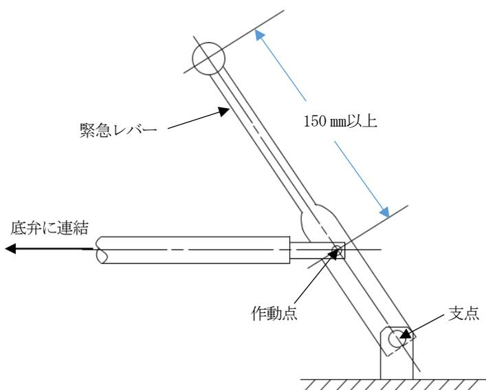
第9-37 図 緊急レバーの構造
