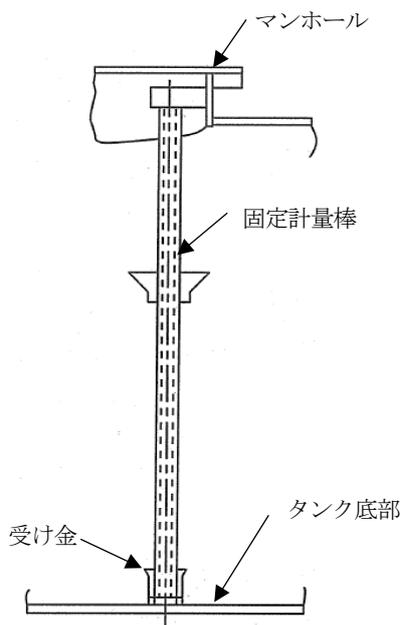
例8 不燃性ガスを封入した状態のまま計量でき、計量棒がタンク底部と接触しなくてもよい例
