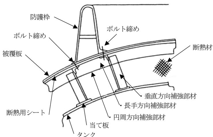
第9-31 図 被覆板の下部に補強部材を設ける防護枠（ボルト締め接合する場合）
