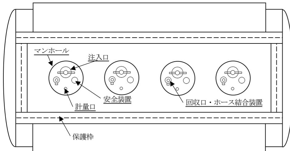
第9-11 図 回収口に直接回収ホースを結合する方式の例
