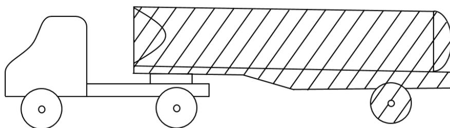
ウ 単一車形式で積載式の移動タンク貯蔵所の例
