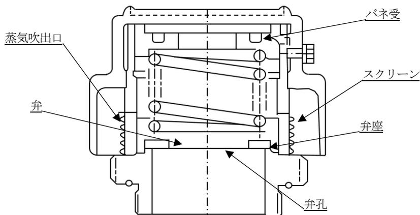
第9-7図 安全装置の構造例
