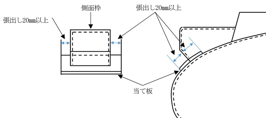
例2 枠形の側面枠に設ける当て板
