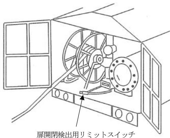
例2 扉ロック用爪の掛け外しによって扉の開閉を検出する方法
