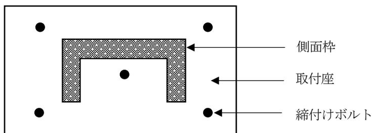
第9-26 図 締付けボルト配列の例
