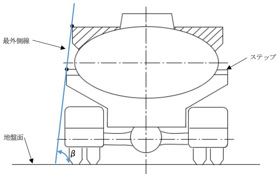
例3 側面枠頂点とタンク側面とを結んだ例
