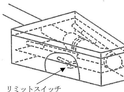
第9-70 図 ノズル格納装置による方法の例
