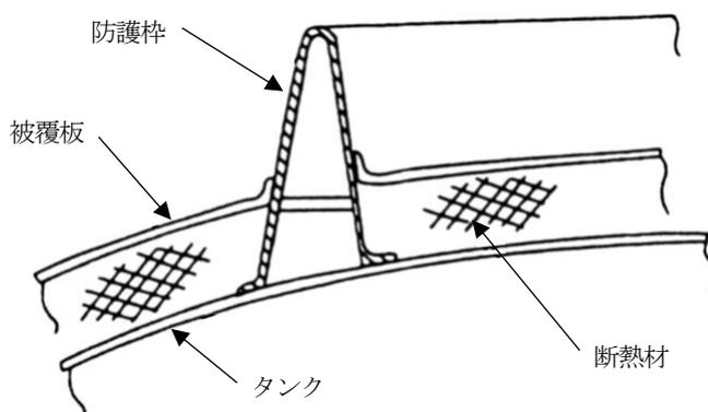
第9-32 図 タンク銅板に直接取付ける防護枠
