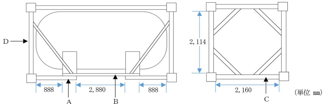
移動貯蔵タンクの移動方向に平行な荷重に対する下けたAの強度計算例
