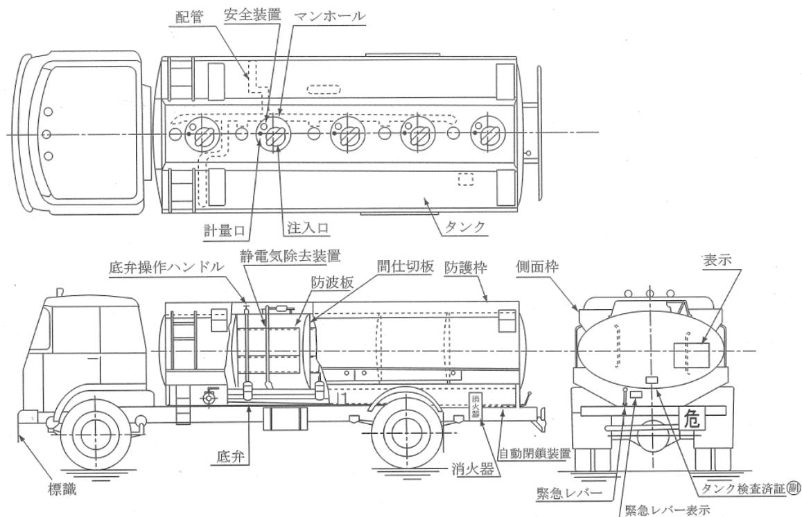
第9-56 図 灯油等（6,000L以下）を貯蔵し、又は取り扱う移動タンク貯蔵所の例
