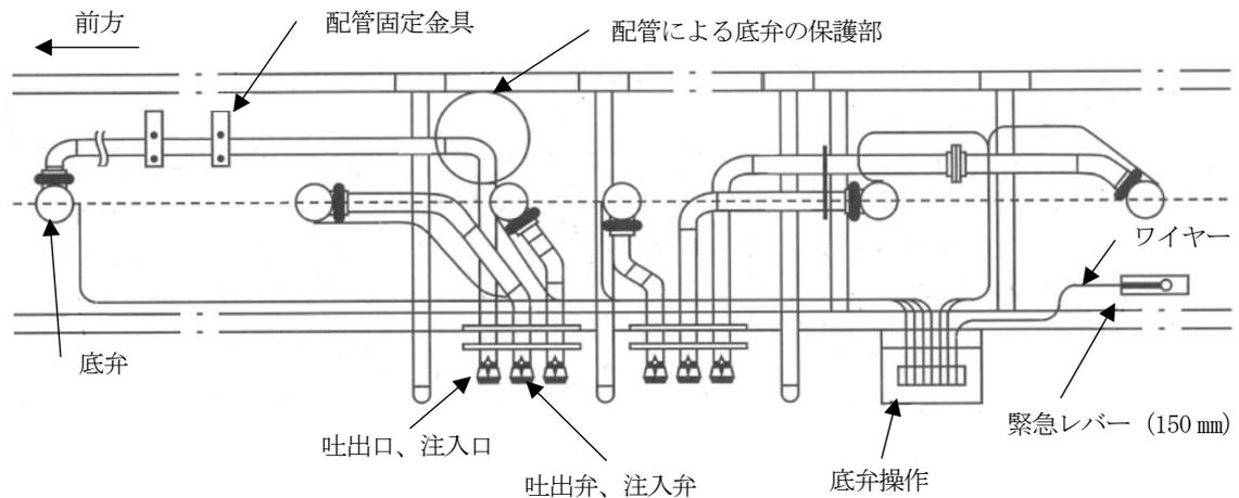
第9-59 図 ボトムローディング配管の例 (片側)
