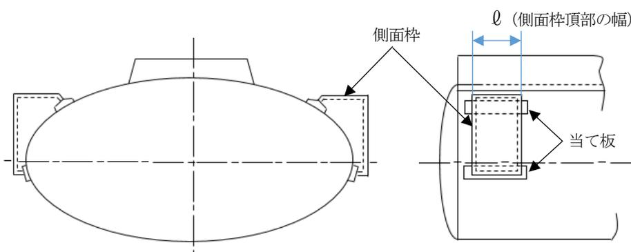
第9-16 図 箱形の側面枠の構造例
