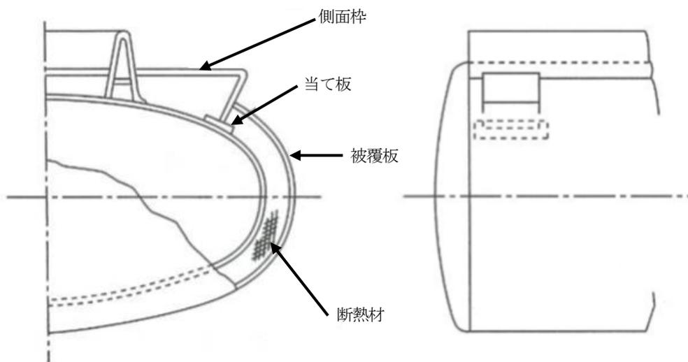
第9-24 図 タンク胴板に直接取付ける側面枠の例
