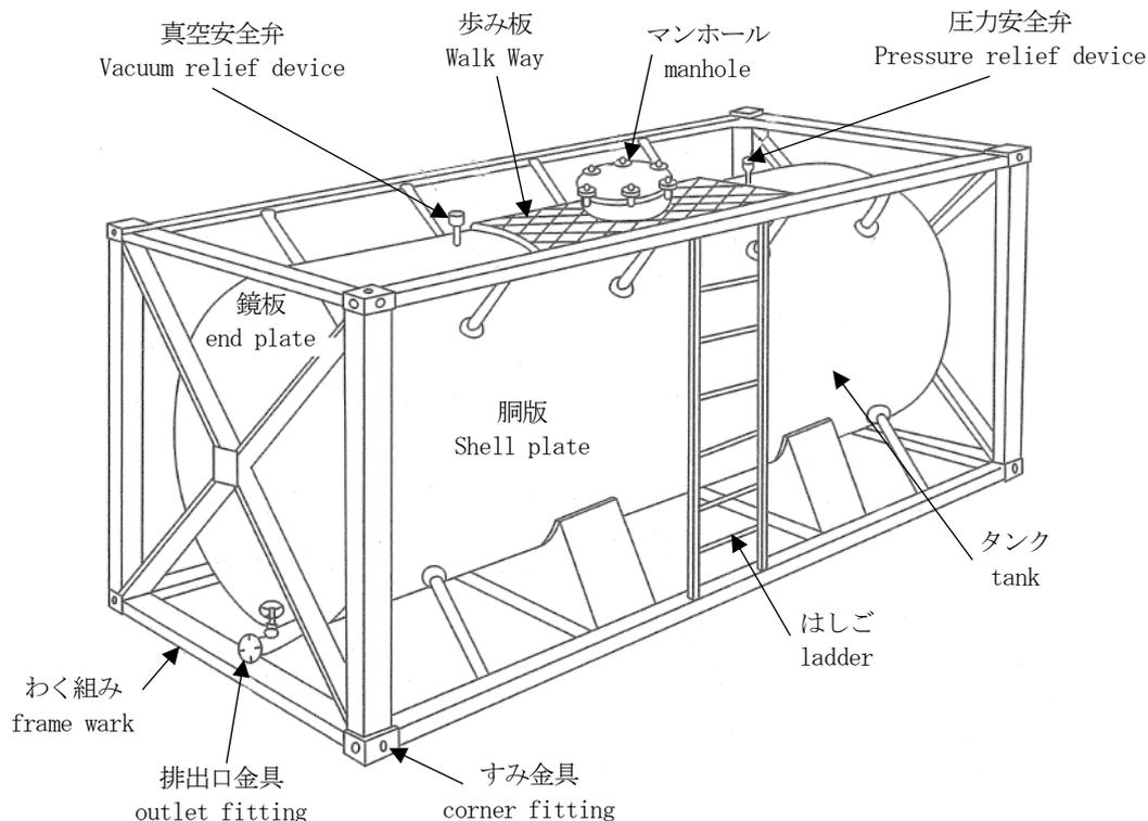
第9-64 図 国際輸送用タンクコンテナの例
