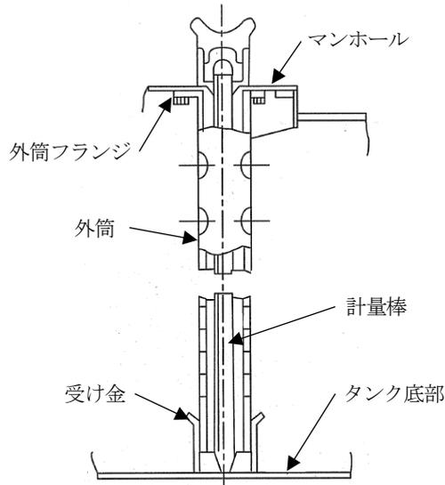
例4 外筒を上下の受け金で取り付ける例
