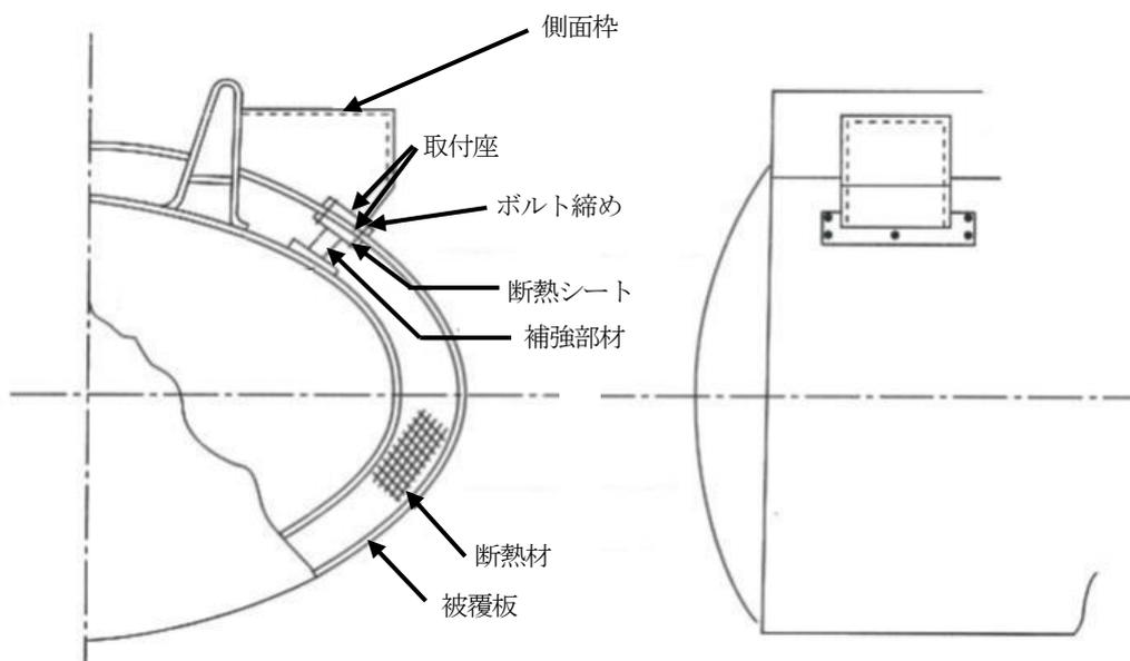
第9-23 図 外板の下部に補強部材を設ける側面枠の例
