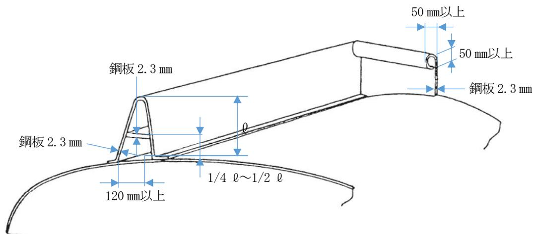
(注) 前部は、直径50mm以上の上部折り曲げ形構造又はパイプ溶接構造とすること。
