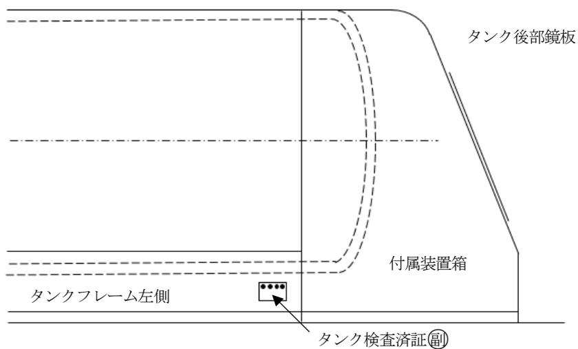
例4 積載式移動タンク貯蔵所で移動貯蔵タンクを前後入れ替えて積載するもの場合(箱枠の例)
