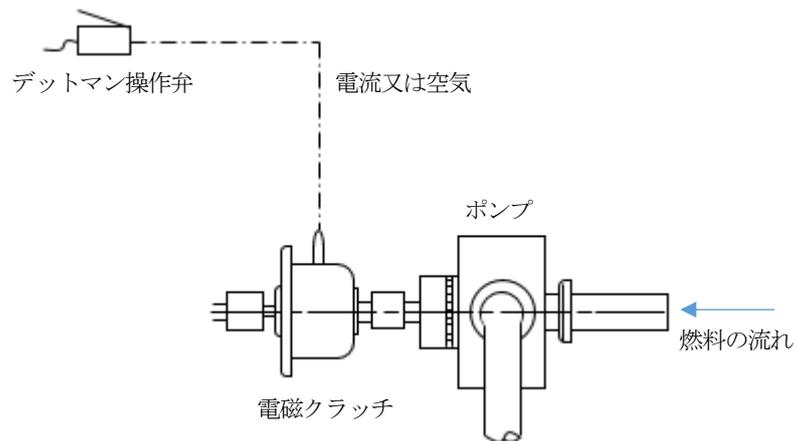
第9-74 図 デッドマンコントロールシステム系統例
