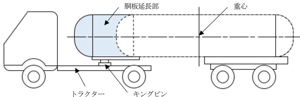
第9-58 図 胴板を延長した移動タンク貯蔵所の例
