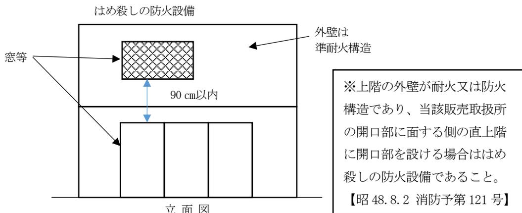
第12-2-2 図 上階への延焼を防止するための措置例②
